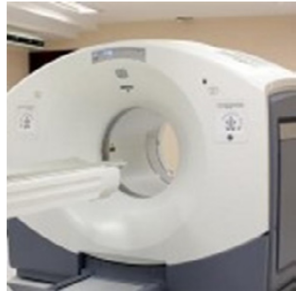
Figura 2: Câmara PET. O equipamento se difere do SPECT por ser um detector circular que permite a captação simultânea das duas radiações gama emitidas através da reação de aniquilação do pósitron com os elétrons do organismo. Fonte: Centro de Imagem Molecular - Faculdade de Medicina/UFMG.
